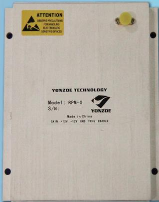
雷达性能监视器是IMO推荐的雷达辅助装置，近期CCS也在强制推进。其作用为是测量雷达收发机性能引起的下降，以提高航行安全。在茫茫大海中航行，没有目测参考目标，雷达性能的下降不容易为人所知，从而引发航行安全隐患，性能监视器可以定量测出收发机综合性能的下降。
