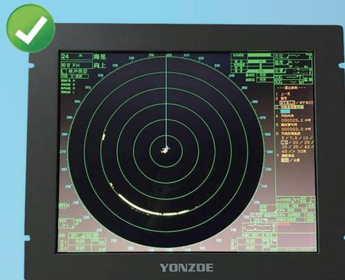
设置合适，如指示弧变弱，雷达能量变小
